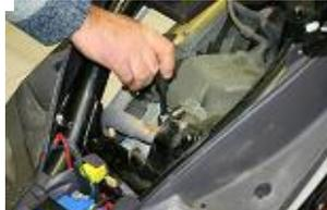
Svitare e deporre le viti di fissaggio collettore di scarico con un cricchetto ed una bussola da 10.
