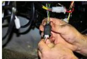
Rimettere la protezione anti umidità sul connettore della centralina MVT.
