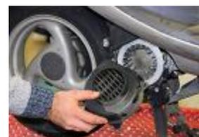
Rimontare il copri ventola con delle viti da 5 mm più lunghe e 3 spessori da 7 mm per i modelli ad aria e sigillare con del nastro adesivo lo spazio creatosi.
