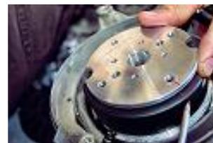
Posizionare un'asticella nel foro della candela e ruotare l'albero motore per posizionare il motore al punto morto superiore; piazzare il rotore sull'albero facendo coincidere le 2 tacche rosse del rotore e dello statore.
