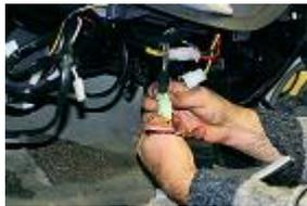
Collegare il connettore della centralina MVT con il connettore originale del CDI.
