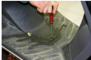
Svitare le viti inferiori del copribatteria, con una torx T20 o un cacciavite a taglio.
