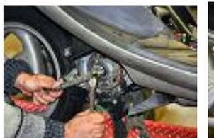
Svitare il dado da 14 che stringe il volano avvitare l'estrattore Peugeot per togliere il rotore con delle chiavi apposite.
