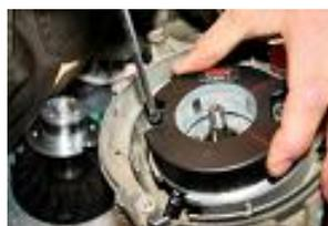
Recuperare il passacavo sul rotore d'origine e posizionarlo sulla guaina dell'accensione PREMIUM, poi passare la guaina dal foro carter ed avvitare il rotore con 2 viti da 5x30mm e le rondelle fornite.
