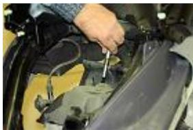
Smontare il blocco pistone, rimettere la candela e la pipetta schermata.
