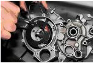
Recuperare in passacavo originale e inserirlo sulla guaina dello statore premium, inserire lo statore sulla piastra e il passacavo nel foro del carter, fissare con le due viti M5 x 30 mm fornite.
