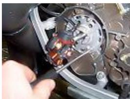
**ATTENZIONE!** Le 3 viti della piastra sono particolarmente difficili da svitare, quindi usare una chiave a brugola da 5 mm e battere con un martello sulla chiave prima di provare a svitare la vite
