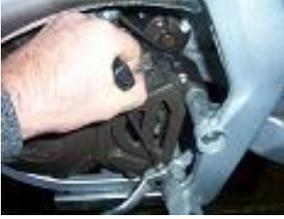
Svitare con una chiave a pipa da 10 mm la vite di fissaggio del selettore e deporla.
