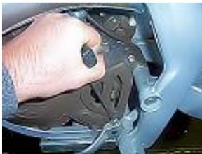
riposizionare con una chiave a pipa da 10 mm la vite di fissaggio del selettore.
