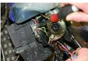
Posizionare la bobina ad alta tensione nella posizione originale, fissando alla massa il cavo nero della centralina e il verde/giallo dello statore.
