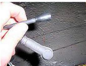
Recuperare il cavo ad alta tensione originale inserirci la protezione anti umidità fornita nel kit MVT
